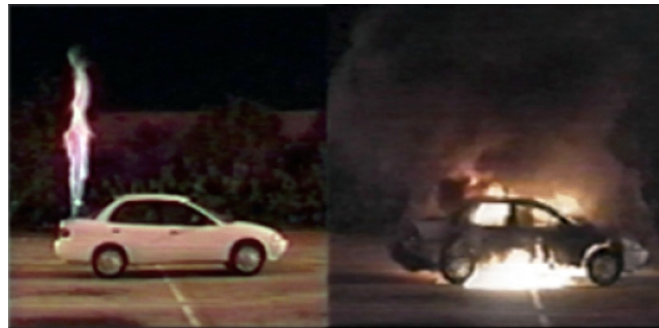
Comparación de los fuegos producidos en un coche de hidrógeno (izq.) y en un coche de gasolina (dcha.). Fuente: Dr. Swain, Universidad de Miami
